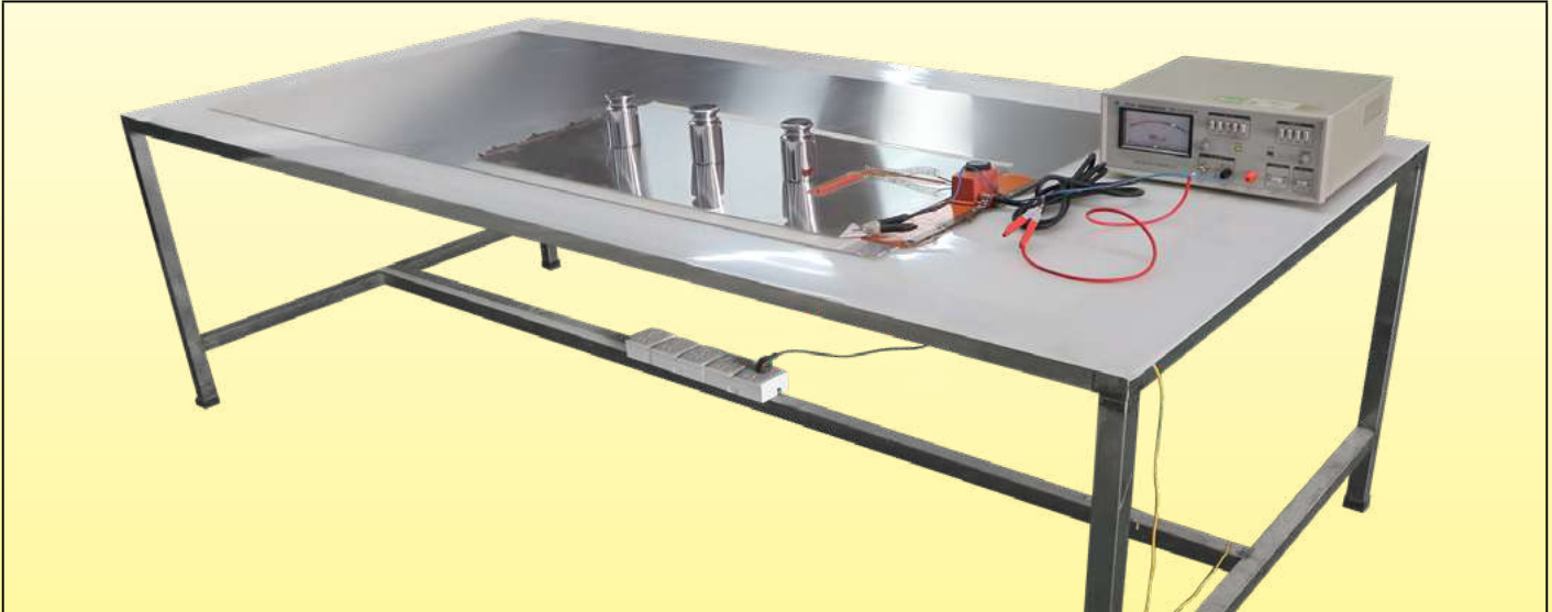
Dispositivo per la misurazione della resistenza di isolamento. I valori misurati sono sempre superiori a 0.1Gohm.
